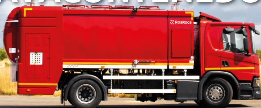
El **lavacontenedores**, realiza una eficiente limpieza interior y/o exterior de cubos y contenedores. Permite lavar indistintamente cubos de 80 a 390 litros mediante peine, contenedores de 500 a 1.200 litros tapa plana y contenedores de 770 a 1.300 litros mediante peine o brazos. Todos ellos resumidos en la norma EN840-1/2/3.
